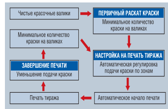
Система RPI регулировки подачи краски
