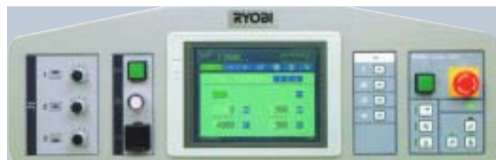
Центральная панель управления машин Ryobi серии 520HXX
