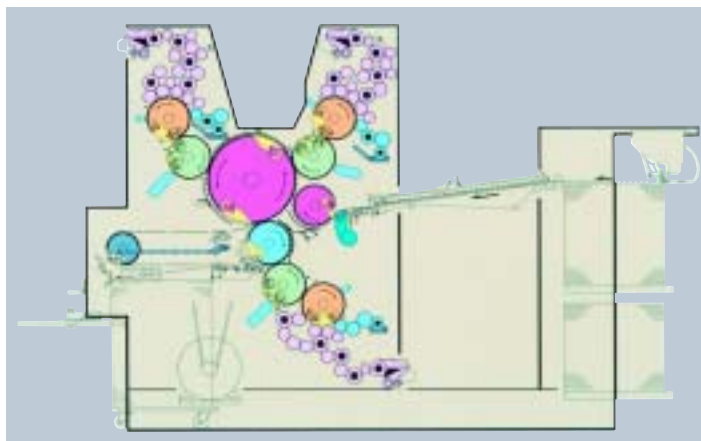
Конструктивная схема печатной машины Ryobi 662PFHX
