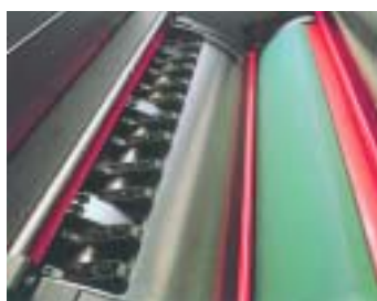
Двухпружинный торсионный механизм захвата бумаги
